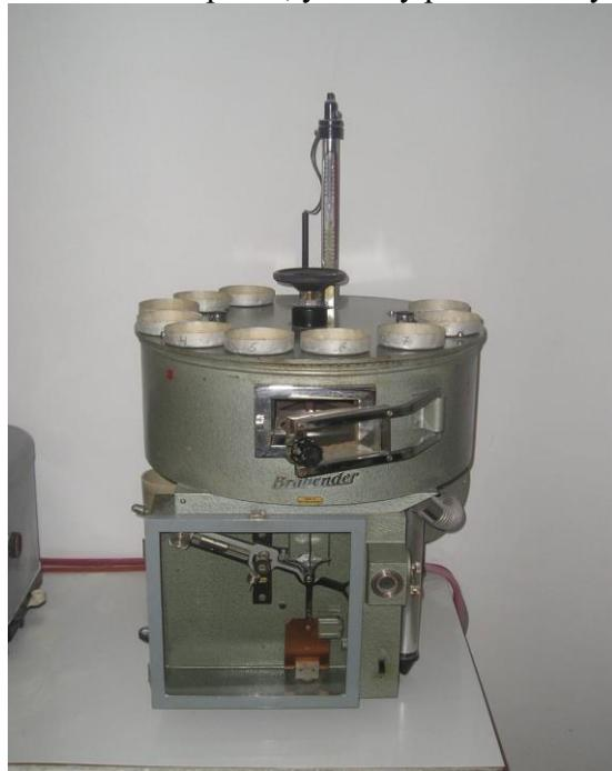
**Рис. 2. Напівавтоматична сушильна шафа Брабендера**
