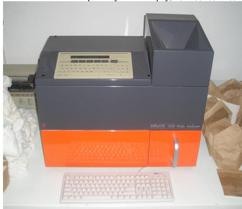
Рис. 3. Аналізатор «Infratec 1225»
