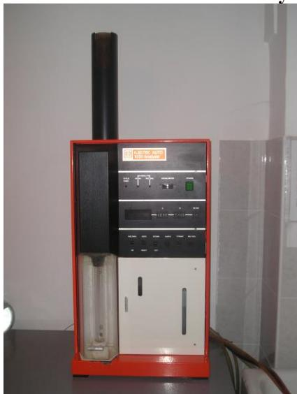
**Рис. 16. Загальний вигляд приладу Kjeltec Auto-1030-Analyzer**
