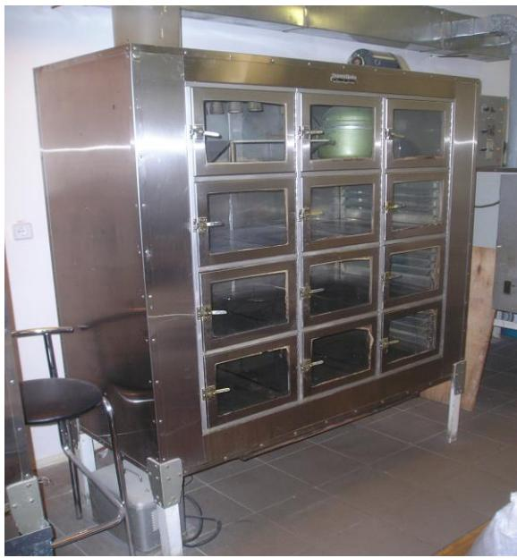
**Рис. 14. Термостат для бродіння і розстойки тіста**
