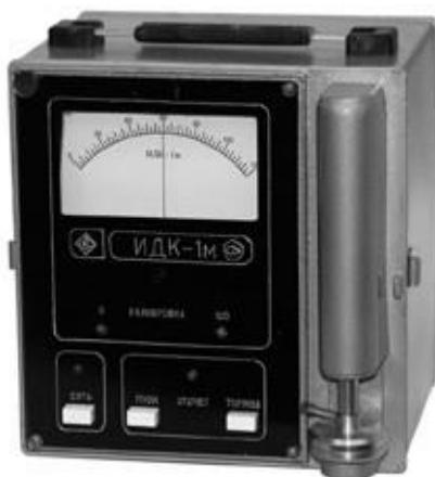
**Рис. 6. Прилад для вимірювання індексу деформації клейковини «ВДК-1»**
