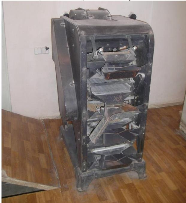
**Рис. 1. Лабораторний зерноочищувальний прилад**
